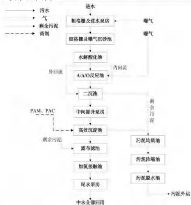
图 4-2 浦口经济开发区处理厂污水处理工艺流程图
