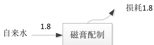
图 2-2 本项目建成后全厂水平衡图 (t/a)
