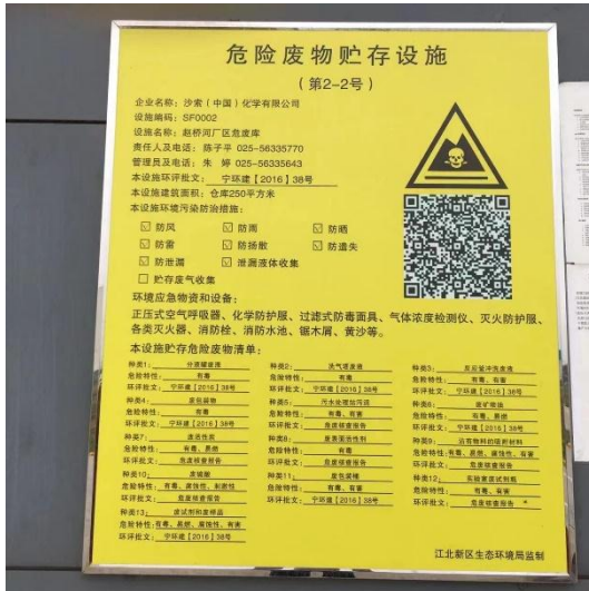
危险废物贮存设施标识
