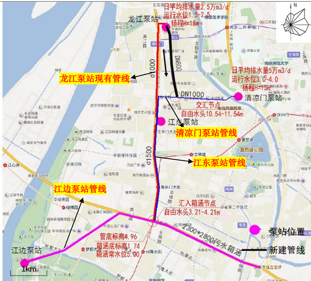
图 1-8 项目建成后泵站及污水管线运行情况
